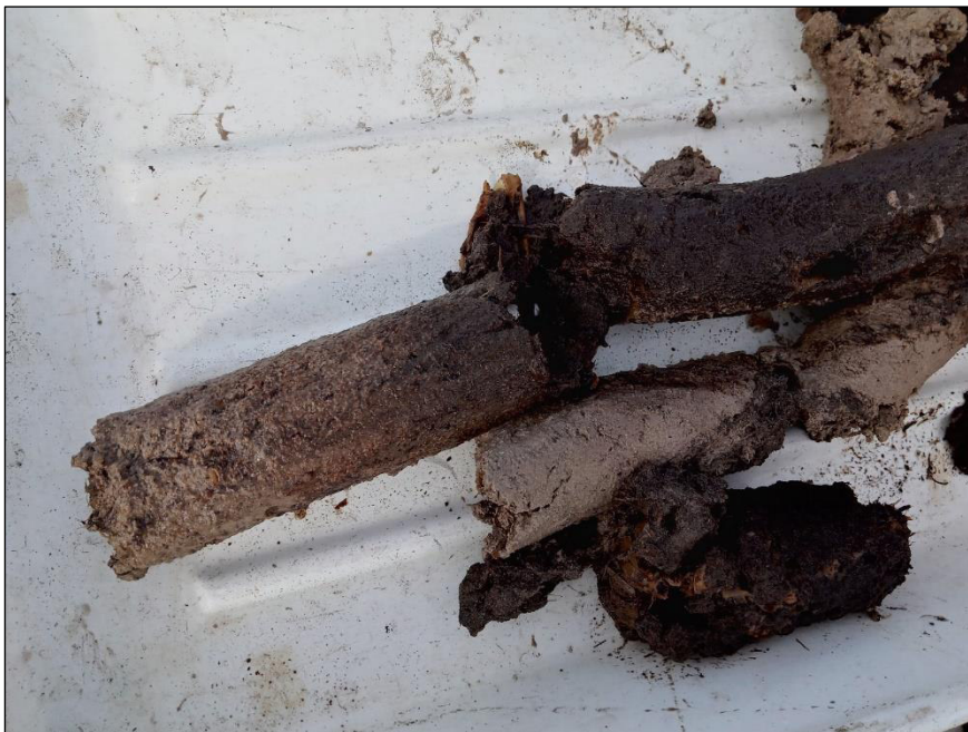
Abb.5.3-5 : Sediment im Reimershagener See, überwiegend bestehend aus Detritusmudde; anstehender tonig-sandiger Boden (hell)
