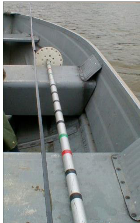
Abb.5.3-1: Mechanisches Sondiergestänge (links im Foto) zur Erfassung der Schlammmächtigkeit
