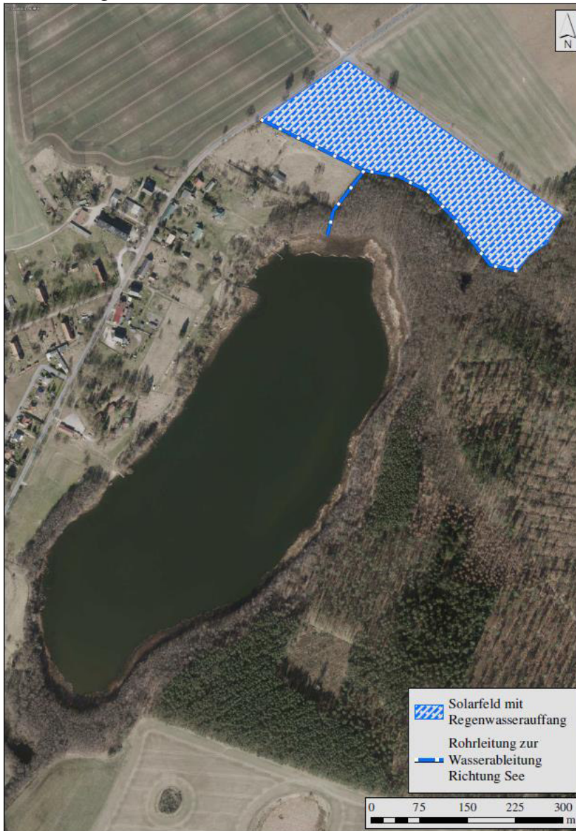
Abb.6-7: Hängige, nordwestlich gelegene Ackerfläche, für die die Anlage eines Solarfelds zur Erosionsminderung mit Direkteinleitung von Regenwasser in den See vorgeschlagen wird.
